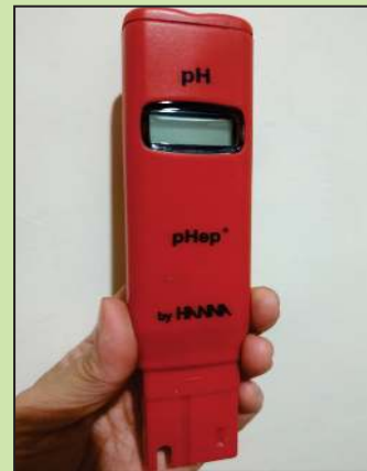
Gambar 4.6. pHmeter digital Sumber: Kemendikburistek/Elizabeth T. (2021)
