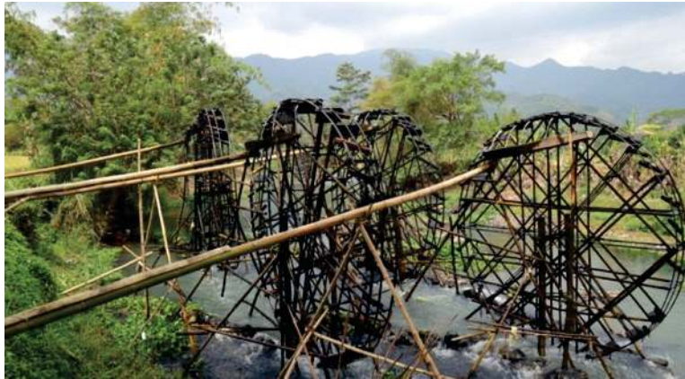
Gambar 6.1. Kincir air untuk mengairi sawah.
